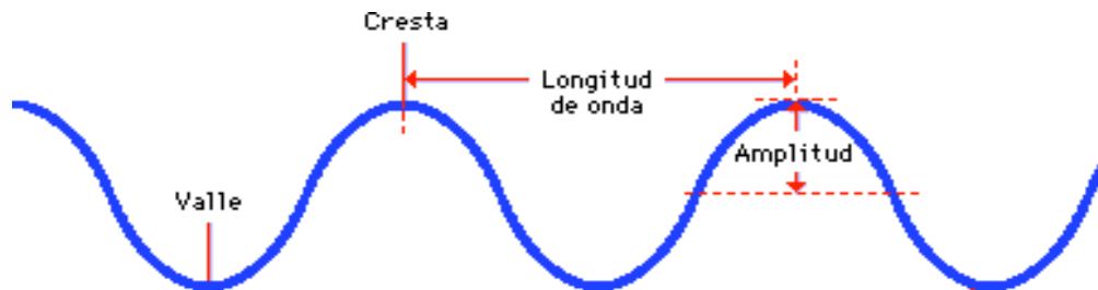
Figura 19. Se utiliza una cuerda para ilustrar la naturaleza de las ondas S
